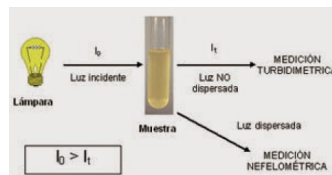
Fig. 2 Diferencia entre medición por turbidimetría y nefelométrica, la primera mide la luz transmitida, la segunda mide la luz dispersada.
