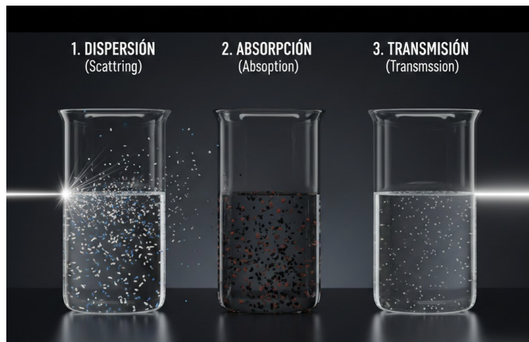
Fig. 3: La luz dirigida a través de una solución turbia que contiene partículas sólidas en suspensión puede transmitirse, absorberse (bloquearse) y dispersarse. (Imagen elaborada con Google Gemini)
